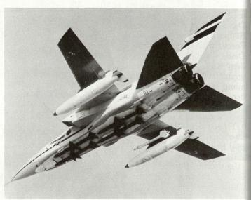
Bild 5. Typische Zuladung einer Tornado F2. Sie besteht aus 4 Sky-Flash- und 2 Sidewinder-Luft-Lenkwaffen sowie 2 Zusatztanks.
