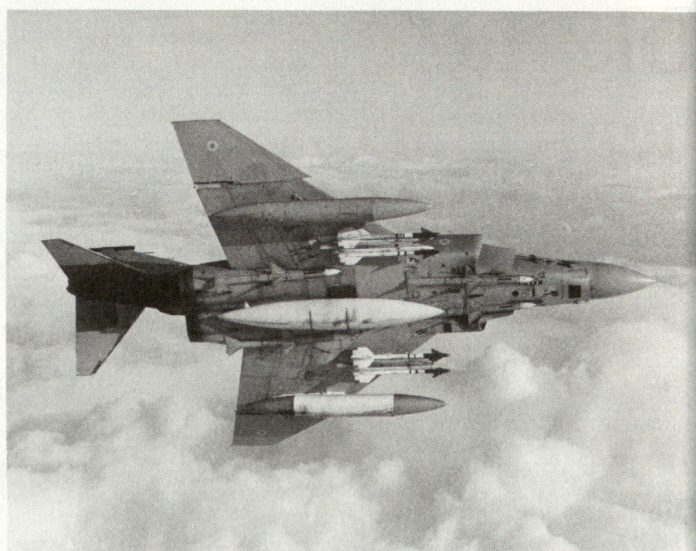
Bild 3. Eine Phantom F-4K der RAF-Staffel No 111. Die Waffenzuladung besteht aus 4 Sidewinder- und 4 Sparrow-Luft-Luft-Lenk Waffen sowie 3 Zusatztanks. Dank der echten «look down – shoot down»-Kapazität werden die flugtüchtigen Phantoms noch im Einsatz belassen.
