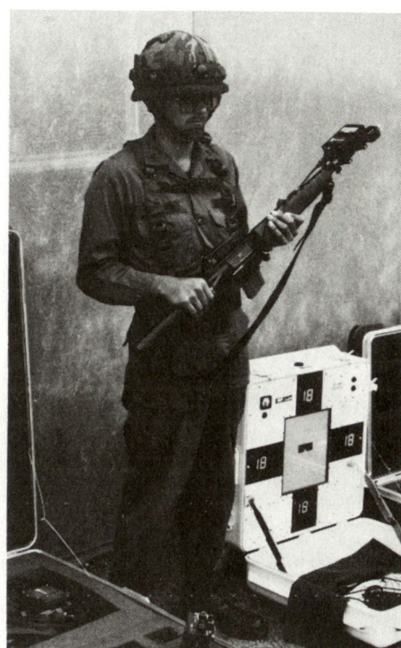
Ausrüstung mit 5 Detektoren montiert. Auf das Gewehr wird der Lasersender aufgesetzt und justiert.
