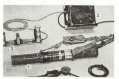
Bild 1: Strahlenwarn- und Aufklärungsgerät RWA 72 K.
