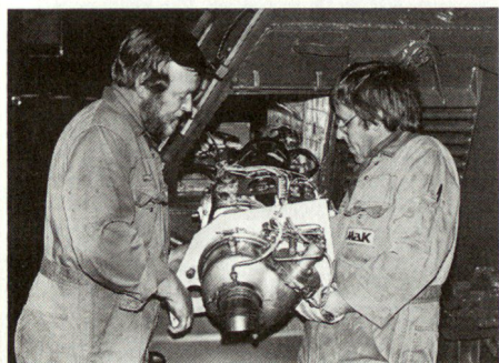
Einbau des Gasturbinen-Stromerzeugungsaggregats an der linken hinteren Kettenschulter des Schützenpanzers «Marder».
