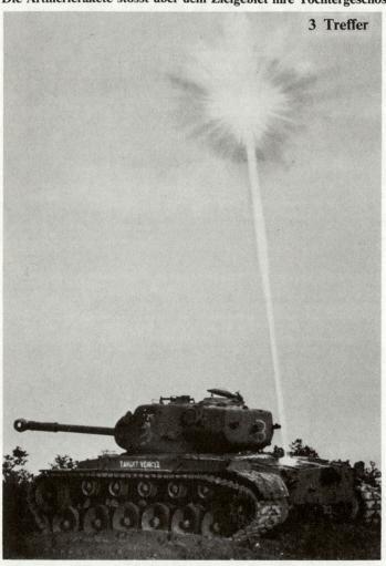
Zirka 20 m über dem Ziel bildet sich durch Explosion des Geschosses ein Projektil, welches den Panzer mit hoher Geschwindigkeit trifft.
