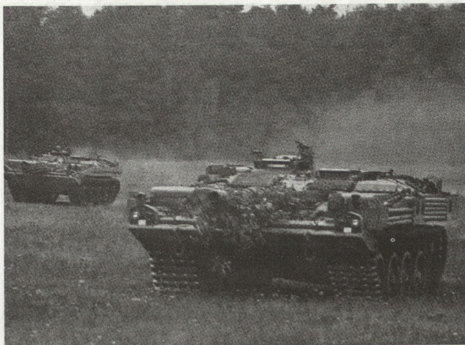
Bild 5. Die Panzerbrigaden des Heeres sind mit dem in Schweden hergestellten Panzer S mit einer vollautomatischen 105 mm in Chassis fest montierten Kanone ausgerüstet. Er hat ein niedrigeres Profil als alle anderen vergleichbaren Panzer.
