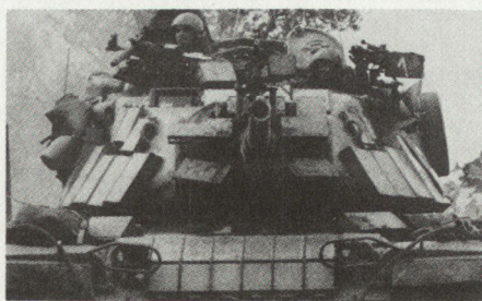
Bild 1: Israelischer Kampfpanser M 48/105 mit Aktivzusatzpanzerung.
