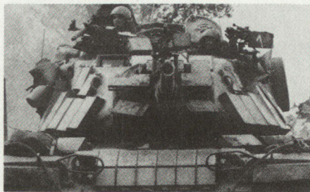
Bild 1: Israelischer Kampfpanzer M 48/105 mit Aktivzusatzpanzerung.
