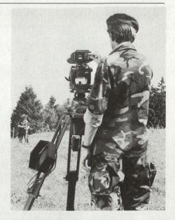
mil), Horizontal- und Vertikalwinkel ( $\pm 0.2$  mil bis  $\pm 0.05$  mil je nach Modell) sowie die Entfernung bis zu 14 km bei einer Genauigkeit von  $\pm 2$  cm innerhalb kürzester Zeit. Horizontaldistanz, Höhenunterschied und Koordinatenwerte zwischen Station und Zielpunkt können vom Gerät berechnet und dadurch die Lage und Richtung der Geschütze in wenigen Minuten bestimmt werden.
