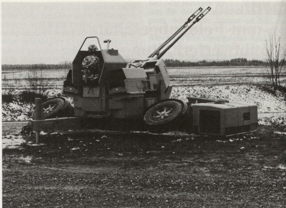
Oerlikon 35-mm-Feldflabgeschütz mit neuem 3D-Minivisier, mit Nachladeautomaten und der auf der Unterlafette integrierten Energieversorgungsanlage.
