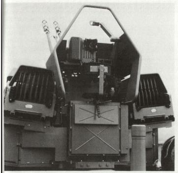
Minivisier Gun-King von Contraves integriert auf dem Oerlikon 35-mm-Fieldflabgeschütz.
