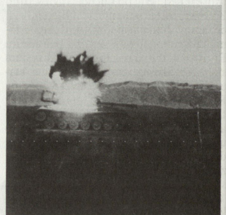
Bild 4. Direkttreffer auf einen mit 20 km/h fahrenden Panzer M-47 über eine Distanz von 6,1 km.
