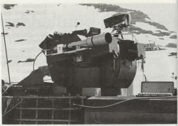
Bild 3. Zielgeräte TV-Kamera mit 1600-mm-Objektiv.
