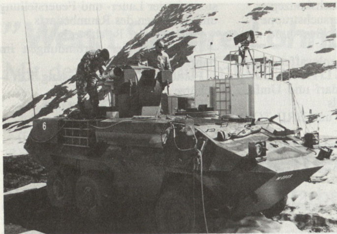
Bild 2. Justierung der Zielgeräte TV-Kamera mit eingeblendetem Fadenkreuz. Im Hintergrund Versuchseinsatzwagen 1 mit einer Schwarz-/Weiss-TV-Kamera, diese dient zur Aufnahme der Lenkwaffenflugbahn.
