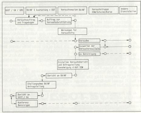
Ablaufschema für die Durchführung von Versuchen
