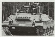
Kampf gegen die vorhandene Überzahl an Panzern des Warschauer Pakts. Der Jaguar 2 ist mit dem Panzerabwehrraketensystem TOW ausgestattet, mit dem angreifende Panzer auf eine Entfernung bis 3000 m bekämpft werden können. Der Jagdpanzer ist durch ein Nachtziel- und Beobachtungs-
