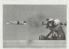
BILL zeichnet sich in mehreren Punkten aus. Sie fliegt über der Ziellinie, und die Hohlladung wird durch Annäherungsfunktion ausgelöst. Somit überfliegt die Waffe auch Hindernisse im Gelände und greift Kampfpanzer von oben an. Dadurch werden die schwächer gepanzerten Teile des Panzers getroffen, und die Sprengladung hat einen kürzeren Durchschlagsweg.
