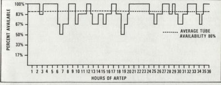
Abbildung 1. Prozentuale Verfügbarkeit der Rohre einer US-Abteilung (2 Bttr zu 6 M 109 A1) während einer 36stündigen Übung (aus Field Artillery Journal 5/83 S. 12)
