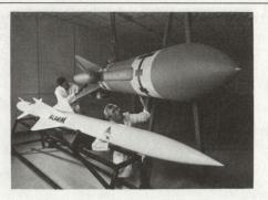
geschrittensten Luftabwehranlagen ausgestattet sind. Die Sea Eagle wird durch einen digitalen Bord-Mikroprozessor gesteuert, in den vor dem Abflug Ziel- und Flugdaten eingespeist werden. Sie besitzt einen von Marconi Space and Defence Systems entwickelten aktiven Radarsucher und wird durch eine Gasturbine angetrieben.
