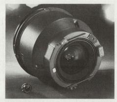
Das Foto zeigt rechts das neue Wild-Weitwinkelobjektiv Universal-Aviogon 15/4 UAG (Bildwinkel 90°, Brennweite 153 mm), links daneben das Leica-Superangulon (Bildwinkel 92°, Brennweite 21 mm).
