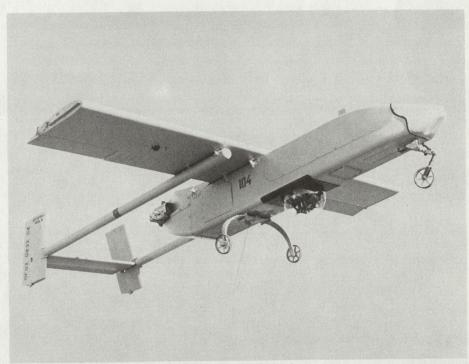
Bild 1. Das von der «Israel Aircraft Industries entwickelte «Scout»-Kleinflugzeug mit schwenkbarer Mini-Fernsehkamera und Fotogerät für Panoramaaufnahmen. Das Fahrwerk ist bei neueren Modellen durch Kufen ersetzt worden.
