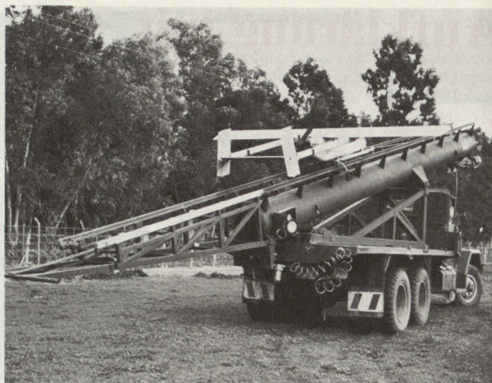
Bild 3. Werferfahrzeug mit Startschiene und der Druckluftflasche.
