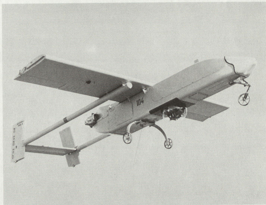
Bild 1. Das von der «Israel Aircraft Industries» entwickelte «Scout»-Kleinflugzeug mit schwenkbaren Mini-Fernsehkamera und Fotogerät für Panoramaaufnahmen. Das Fahrgestell ist bei neueren Modellen durch Kufen ersetzt worden.
