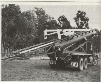
Bild 3. Werferfahrzeug mit Startschiene und der Druckluftflasche.
