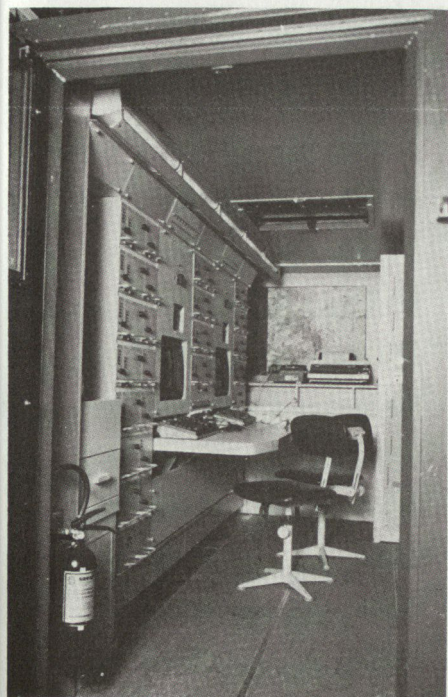
Kabine mit Schaltkoffern des ZODIAC-Systems.
