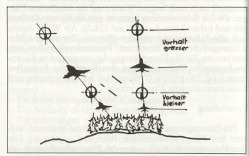
Visierverhältnisse bei einem Überflug. Die Zielbewegung wird immer schneller, je näher das Flugzeug kommt, was mehr Vorhalt bedeutet.
