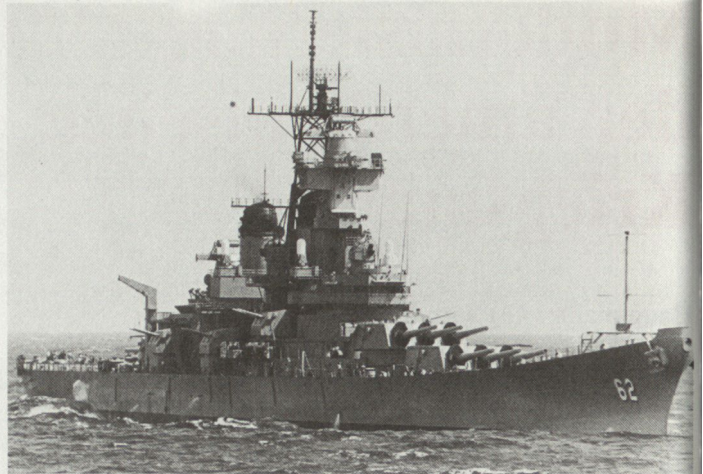
Am 28. Dezember 1982 wurde das ursprünglich am 23. Mai 1943 erstmals in Dienst gestellte Schlachtschiff USS «New Jersey» in Long Beach, Kalifornien, im Beisein von Präsident Reagan nach verschiedenen Stilllegungsperioden erneut in Dienst gestellt. Das 58 000 Tonnen schwere und über 30 Knoten schnelle Schiff ist erheblich modernisiert worden. So gehören zur Standardbewaffnung von 9 × 40,6-cm-Geschützen neu vier «Vulcan-Phalanx»-Nahbereich-Fliegerabwehrkanonen, acht Startbehälter für je vier «Tomahawk»-Marschflugkörper sowie vier Startbehälter für je vier «Harpoon»-Schiff-Schiff-Lenk Waffen. Die «New Jersey» wird inskünftig mit der Pazifikflotte operieren.
