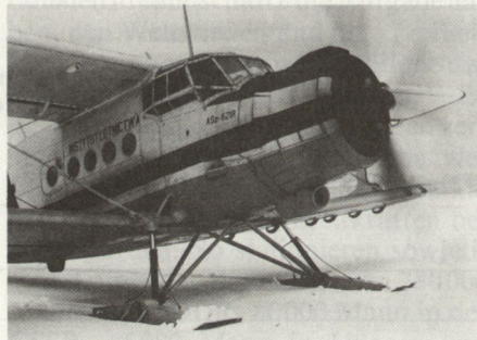
Das russische Mehrzweckflugzeug Antonov AN-2. Diese Maschine bewährt sich in Sibirien wie in den tropischen Klimazonen. Sie wird in einer Passagier-, Transport-, Sanitäts-, Kommando- und Landwirtschaftsversion gebaut. Sie kann wahlweise mit Schwimm- oder Skivorrichtung ausgerüstet werden.
