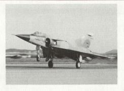
wire»-System wurde von der Mirage 2000 übernommen. Das Navigations- und Waffenleitsystem basiert teilweise auf jenem der Mirage F.1 und der Mirage 2000, ebenso die Systeme für elektronische Warn- und Störmassnahmen.
