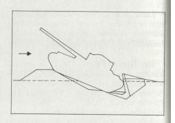
Angriff von hinten. Der Panzer muss sich über die Kante des oben abgeschrägten Betonelementes in den Graben fallen lassen. Der nun in einem Winkel von zirka 45° gekippte Panzer gräbt sich immer tiefer mit den Raupen in das Erdreich des Grabenprofils ein und kann sich nicht mehr befreien.
