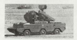
vereinfacht werden. Das schwimmfähige Basisfahrzeug, das Zielerfassungs-, Feuerleit- und Rundsuchradar sind unverändert. Die beiden Bilder zeigen die 50prozentige Kampfwertsteigerung durch die Aufnahme von insgesamt sechs Flugkörpern und die primäre Einsatzverwendung den Schutz von WAPA-Panzer- und MotSchützen-Divisionen in vorderster Front, gegen Luftangriffe aus mittleren Höhen zu übernehmen.
