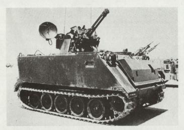
Theoretische Kadenzen von bis zu 10000 Schuss pro Minute sind möglich. Gegen schnelle Flugziele wird mit 3000 Schuss/Min. geschossen. Der Flugabwehrpanzer M-163 «Vulcan» wird häufig mit dem Chaparral-System zusammen eingesetzt. Die Distanz zum Ziel wird mit einem Radar festgestellt (keine Radar-Feuerleitung).
