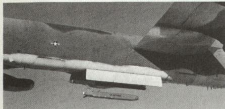
ALCM ausgerüstet sein. Insgesamt sollen 705 Einheiten gebaut werden. Die B-52 können mit 12 ALCM an Flügelstationen und 8 ALCM im Rumpfschacht eingesetzt werden. Die neuen amerikanischen Bomber B-1B werden 14 ALCM extern an den Flügeln und 8 ALCM im Rumpfschacht einsetzen können.
