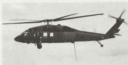
Der Sikorsky «Quick Fix» Helikopter für die U.S. Army zur Störung gegnerischer Radioverbindungen auf dem Gefechtsfeld.
