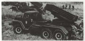
Bild 11. Raketenwerfer B-21 mit 40 Rohren, Standardausrüstung der Panzer- und MotSchützen-Divisionen.
