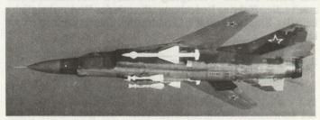
Bild 7. Abfangjäger und Luftüberlegenheitsjäger Mig-23 «Flogger B», 2500 km Reichweite.
