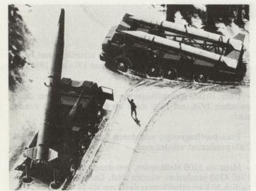
Bild 2. Taktische Boden-Boden-Rakete «Frog», geeignet für Nukleareinsatz.
