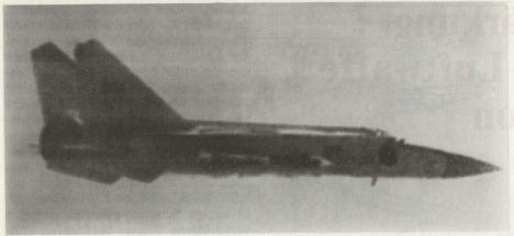
Bild 3. Einsitzige MiG-25 «Foxbat» der libyschen Luftwaffe. Unter dem Flügel ist eine «Acrid» AA-6 Luft-Luft-Lenkwaffe angebracht.
