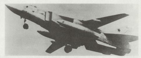
Bild 2. Der Schwenkflügler vom Typ Sukhoi Su-24 «Fencer» ist speziell für Interdiktioneinsätze eintworfen worden und kann feindliches Radar problemlos unterfliegen. Diese Maschine verfügt über eine Geschwindigkeit von mehr als 1000 km/h bei einem Einsatzradius von 1800 km. Die Waffenzuladung soll 2500 kg betragen.
