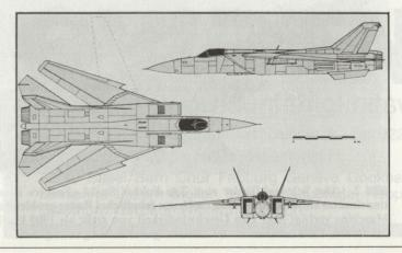
Mach 1,2, auf 9000 Metern Mach 2,8. Die auf den Abfang ausgerichtete Bewaffnung besteht aus 8 radargesteuerten Luft-Luft-Lenkwaffen, und für die Nahabwehr ist eine 30-mm-Schnellfeuerkanone mit einer Kadenz von mehreren tausend Schuss pro Minute vorgesehen.
