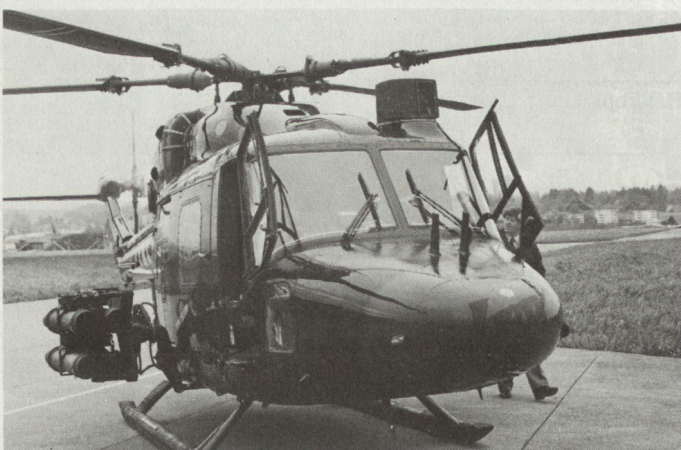
Bild 3. Multirolle-Helikopter haben im Rahmen der verfügbaren Gesamtzuladung Kampffähigkeit und/oder Transportkapazität. Sie sind relativ rasch und vielfältig umrüstbar. Auf dem Bild ein Westland AH 1 Army-Lynx mit der PAL TOW (GB).
