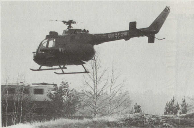
Bild 1. Einfachen Panzerabwehrhelikoptern, die ursprünglich als Verbindungs- und Beobachtungshelikopter konzipiert wurden, ist ein Luft-Boden-Panzerabwehrlenkwerkssystem permanent integriert worden. Er verschiebt sich im Schleichflug und kämpft aus halbgedeckten Stellungen im feindfreien Gelände. Auf dem Bild eine MBB Bo-105 mit der PAL HOT (BRD).
