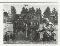
Hell-Feldbildschreibern vorgeführt wurde, eignet sich sowohl für die Übertragung von Sprache als auch von Daten. Besondere Merkmale dieses Delta-Multiplexsystems sind seine äusserst robuste, wasserdichte Bauweise und sein Schutz gegen jegliche Fremdspannungen wie EMP und Blitzschlag sowie seine elektromagnetische Verträglichkeit.
