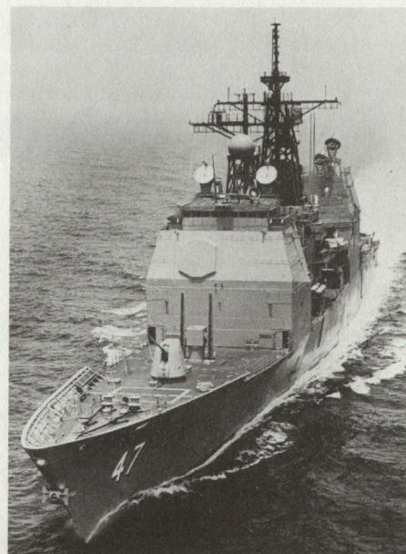
Schiff mit einem neu entwickelten «phased array»-Radarsystem und Lenkraketen ausgestattet. Es sind sechs Kreuzer dieses Typs vorgesehen. jst
