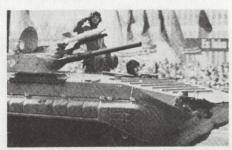
Bild 2: BMP-1 mit 73-mm-Niederdruckkanone und Abschussschiene für PzAbwLFK AT-3/Sagger.
