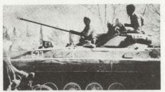
Bild 1: BMP-Nachfolger mit Maschinenkanone 30 mm(?) in Afghanistan.
