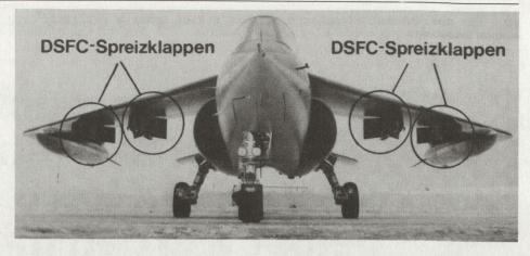
greifen, so dass keine Verschlechterung des Stabilitätsverhaltens des Basisflugzeuges auftritt. Zur Kompensation möglicher Reststörmomente wird jedoch zusätzlich zum bereits vorhandenen Gierdämpfer ein Roll- und Nickdämpfer verwendet. Eine zweite Erprobungsphase soll der Ermittlung der operationellen Vorteile dieser Einrichtung beim realistischen Waffeneinsatz dienen.
