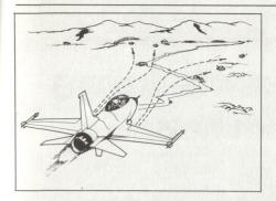
borhaltigen Treibstoffen eignet sich sehr gut als Antrieb für taktische Marschflugkörper der nächsten Generation, bei denen hohe Anforderungen an Geschwindigkeit, Manövrierfähigkeit und Reichweite bestehen. Der Feststau-Antrieb ist für die Verwendung im Flugkörper-Projekt ANS (Anti-Navire Supersonique) vorgesehen. Das Bild zeigt die Startkonfiguration, Tandembooster (Raketenmotor der Honest John) und EFA-Flugkörper kurz nach dem Verlassen der Startlafette.
