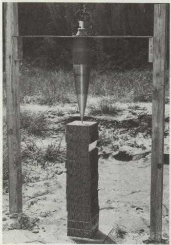
Bild 2. Versuchsanordnung zur Bestimmung der Panzerdurchschlagsleistung.
