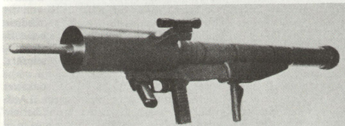
Bild 1: 300 m-Einmann-Handwaffe zur Panzerbekämpfung «Jupiter» von Luchaire, Kal. 115 mm, Gewicht 11 kg. Geringe Abschussignatur.
