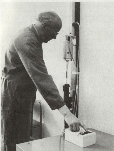
Eine spezielle Überwachungsschaltung zählt die Anzahl der behandelten Läufe und sperrt die Bedienung des Automaten nach dem Ablauf von 2000 Bewegungen, bis eine neue Kupferbürste eingesetzt werden ist.
