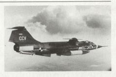
Experimentalprogramm befindet sich jetzt am Ende der mit dem Bundesverteidigungs-Ministerium kontraktierten Phase II, die in der Flugzeug-Konfiguration E3 (höchste Destabilisierungsstufe) gipfelte. Die Beherrschung der CCV-Prinzipien ist für den Flugzeugbau – neben Technologien wie z. B. kohlefaserverstärkte Kunststoffe und fortschrittlicher Aerodynamik – ein Schlüssel zur Leistungssteigerung existierender wie auch zur Entwicklung zukünftiger militärischer Hochleistungsflugzeuge.
