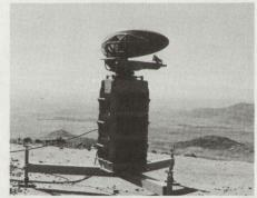
Bild 3. Stentor mit einer Reichweite von 60 km.
