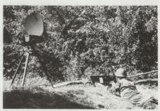
Bild 2. Rasit, Mitte der siebziger Jahre entwickelt, ist tragbar, wiegt weniger als 80 kg und verbraucht nur 130 W, leistet jedoch dasselbe wie frühere Radars.
