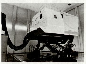
Bild 5. Flugsimulator von Redifon zur Schulung der E-3A (AWACS)-Besatzungen.
