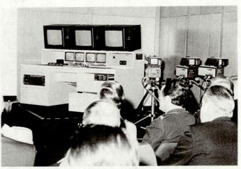
Bild 7. Unterrichtsmitschauanlage, Mehr-Kamera-System.
