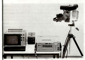
Bild 6. Unterrichtsmitschauanlage, Ein-Kamera-System.
