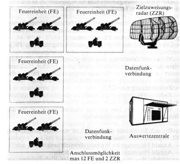
Bild 1. Funktionsschema «Veritas II».
