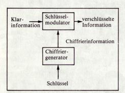
Figur 1: Blockschema eines Chiffriergerätes
