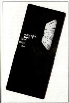
seuchtem Gelände. Dazu ist es mit den beiden Messbereichen 1...1000 mR/H und 1...1000 R/h ausgestattet. Ausserdem besitzt es eine abschaltbare Alarmeinrichtung, deren Signal bei einem Strahlungsanfall von 10...1000 mR/h ertönt. Das Gehäuse ist schlagfest und spritzwasserdicht.
