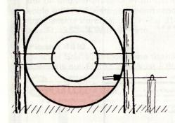
Der Autopneu wird zwischen zwei Pfähle senkrecht gebunden und mit 1 bis 3 Litern Benzin gefüllt. Knapp über dem Benzin wird eine Knallpatrone zur Mark HG 43 so befestigt, dass sie mit einer Schnur abgezogen werden kann.
