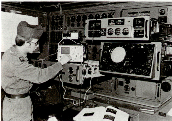
Bild 4. Fehlerlokalisierung durch Flab-Gerätemechaniker an Feuerleitgerät.
