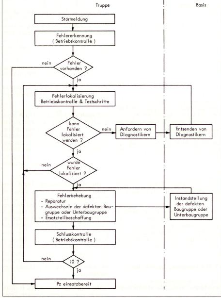
Bild 1. Reparaturablauf.
