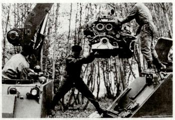
Bild 5. Feldmässiger Ausbau eines Antriebblockes an Schützenpanzer durch Reparaturgruppe.
