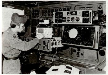
Bild 4. Fehlerlokalisierung durch Flab-Gerätemechaniker an Feuerleitgerät.
