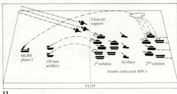
Der für die späten achtziger Jahre geplante Sprengkopf der Phase 3 ist ein Dispenser mit endphasengelenkter Tochtermunition für die Zerstörung von Panzern. Die Endphasenlenkung wird völlig autonom sein. Die Reichweite der Raketen wird zwischen 30 und 40 km liegen.
