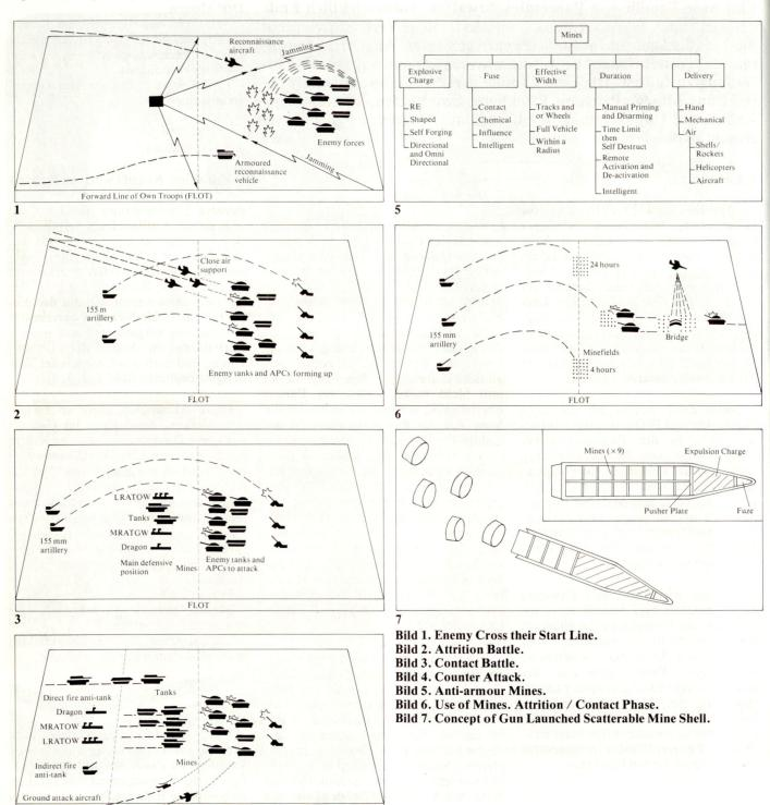
Selbstfahrgeschütz M 109 verfeuern. In jedem 155-mm-Geschoss befinden sich neun Panzerminen, die sich bei geringer Elevation des Rohres auf einer Fläche von 175×175 m verteilen lassen. Eine Batterie von sechs M 109 wäre in der Lage, ein Minenfeld von 350 m Breite und 250 m Tiefe mit zwei bis drei Salven in sehr kurzer Zeit zu verlegen (Bild 6 und 7).
