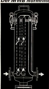
Feststoffmengen aus Flüssigkeiten und Gasen zurückzuhalten. Durch die durchdachte Konstruktion wird die Zeit zum Reinigen des beladenen (verschmutzten) Filters
