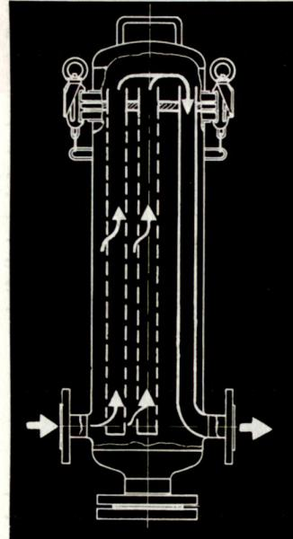
FILTERWERKSTOFF AUS POLYPROPYLEN FILZ (DIVERSE FEINHEITEN, BESTÄNDIG BIS 100° C FÜR VIELE SÄUREN, LAUGEN UND LOESUNGSMITTEL) ODER AUS EDELSTAHL DRAHTGEWEBE. VERLANGEN SIE UNSERE BERECHNUNGSSYSTEME.
