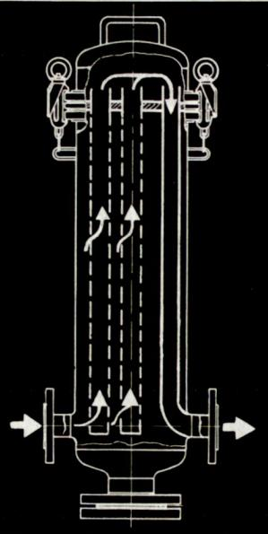
FILTERWERKSTOFF AUS POLYPROPYLEN FILZ (DIVERSE FEINHEITEN, BESTÄNDIG BIS 100°C FÜR VIELE SÄUREN, LAUGEN UND LOESUNGSMITTEL) ODER AUS EDELSTAHL DRAHTGEWEBE. VERLANGEN SIE UNSERE BERECHNUNGSUNTERLAGEN
