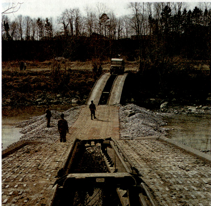
Bild 1. Mittlere Fähre (Schlauchbootbrücke 61) und Übersetzen (Foto Major Stehrenberger).
