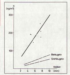
Bild 1. Querschnittsbelastung moderner Infanteriegeschosse in Abhängigkeit des Kalibers.
