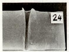
Bild 6. Gleiches Geschoss mit grösserem Drall verschossen, kein Geschosszerfall.
