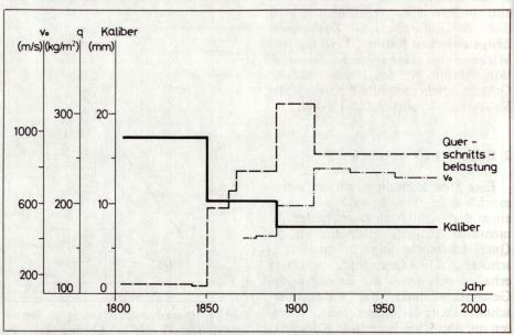
Bild 2. Kaliber, Querschnittsbelastung und voin Abhängigkeit der Zeit.
